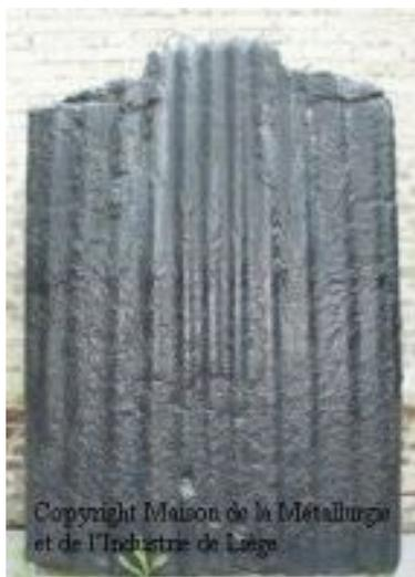
**Premier lingot d'acier (ca. 11 tonnes) produit à l'aciérie de Chertal, par la Société Espérance-Longdoz. Le lingot est cannelé et mesure 180cm de haut, 140cm de large et 58cm de profondeur. Le bordereau de livraison est daté du 4/11/1963. Le lingot est exposé à la MMIL.**
